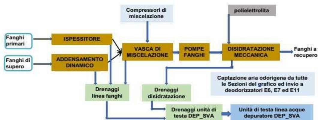
Grafico 5.4B Schema a blocchi esemplificativo della linea fanghi dell'impianto centrale
