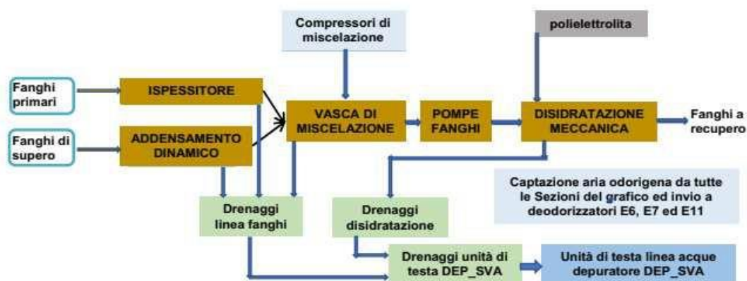
Grafico 5.4B Schema a blocchi esemplificativo della linea fanghi dell'impianto centrale
