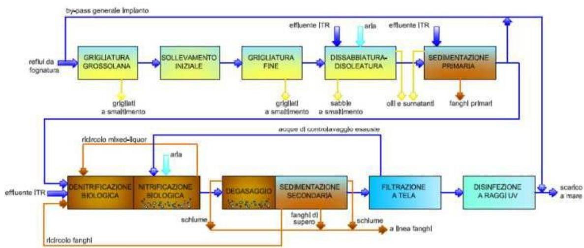
**Opera di presa (Grigliatura):** ha la funzione di eliminare il materiale solido (stracci, plastica e altri oggetti galleggianti) con dimensioni superiori a 6 mm.
