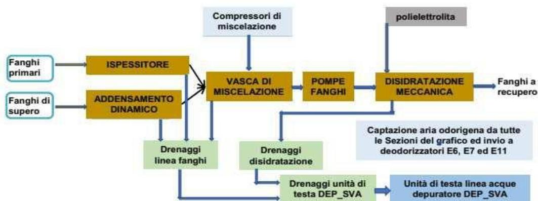
**Ispessitore:** ha la funzione di eliminare ingenti quantitativi di acqua contenuta nei fanghi primari, attraverso un processo prevalentemente a carattere fisico.
