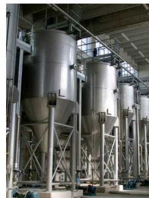
1) stazione di ricevimento: tamburo drenante, cono dissabbiatore- 2) ITR: reattori (mixed settler)-
